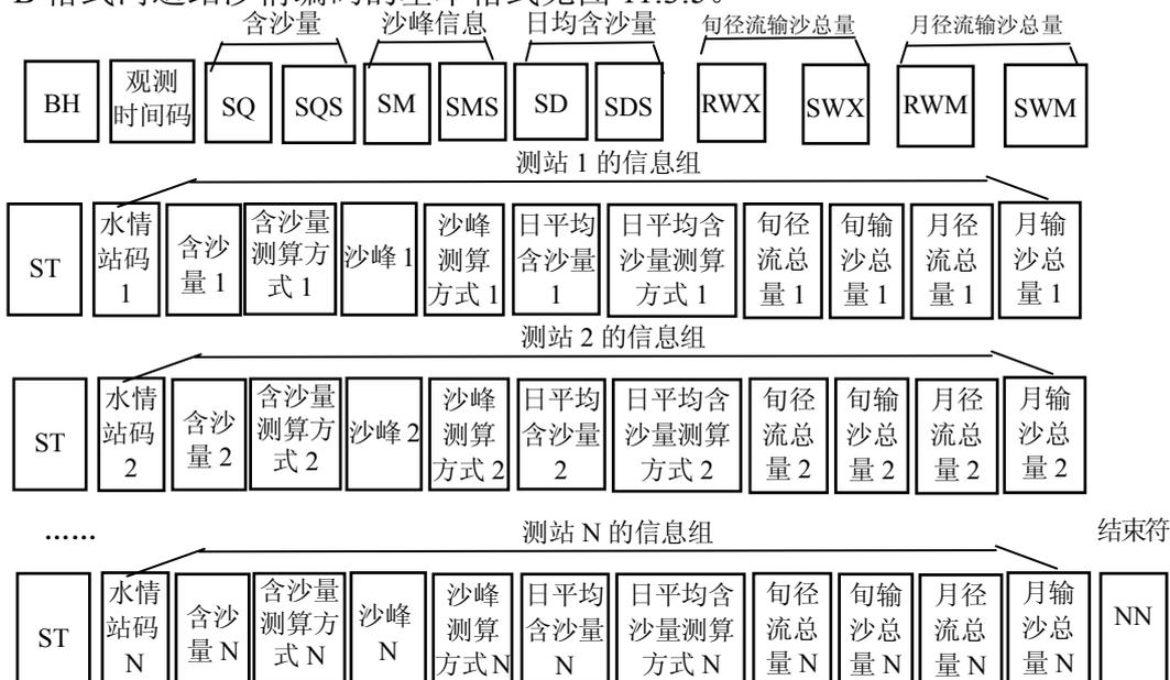
图 11.3.5 B 格式河道站沙情编码的基本格式
